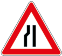
Einseitig (li.) verengte Fahrbahn
