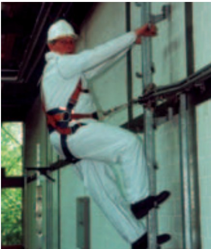
Bild 2-23: Weiche in der festen Führung eines mitlaufenden Auffanggerätes
