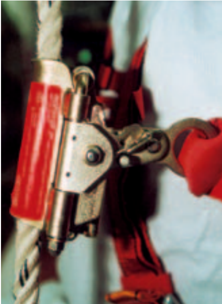
Bild 2-28: Kennzeichnung am mitlaufenden Auffanggerät auf Chemiefaserseil
