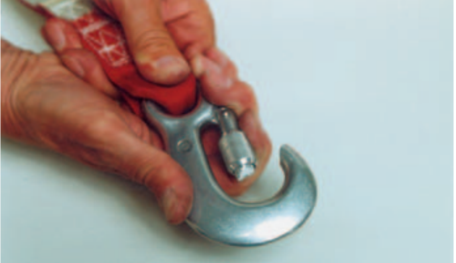
Bild 6-14: Funktionsprüfung der Hakensicherung
