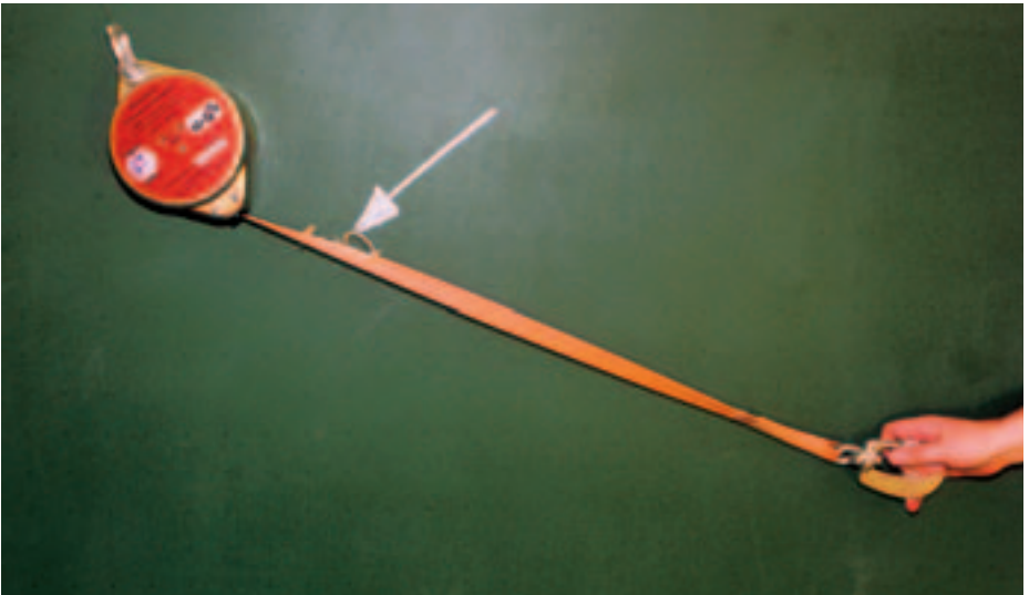
Bild 6-11: Beschädigung am Band
