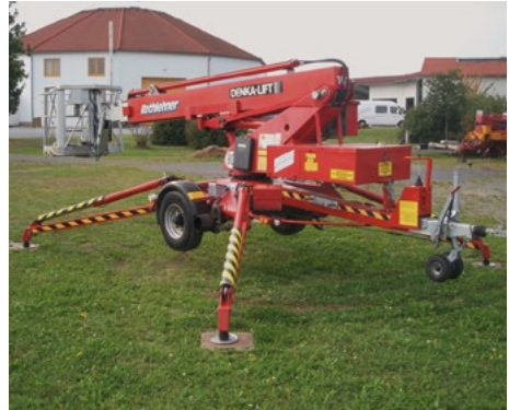
Bild 3-1: Teleskopmastbühne Typ 1B
