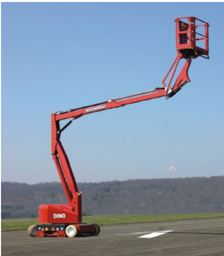
Bild 3-4: Gelenkteleskopbühne Typ 3B
