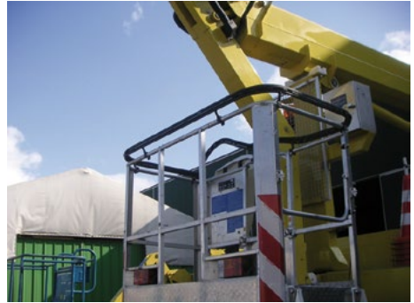
Bild 6-4: Absicherung von Bedienpult und Geländer durch eine Abschaltleiste gegen Quetschgefahren
