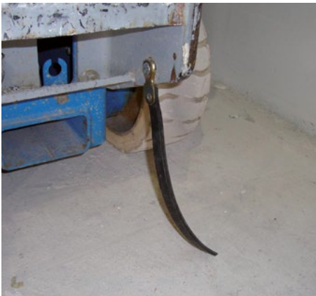
Bild 4-9: Antistatikband zur Ableitung elektrostatischer Aufladungen der Hubarbeitsbühne
